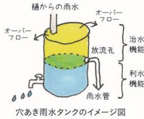
あまみず科学センター（屋根面積 41 m<sup>2</sup>）では、流出の全量を抑制するためには 8.2 m<sup>3</sup>の雨水タンクの容量が必要ですが、10分間のピーク流出量を 60%カットするためには穴あき雨水タンクでは 3.7 m<sup>3</sup>のタンク容量で可能です。既設の雨水管の能力を活用すれば、治水タンクの小型化につながりますし、穴をタンクの中にあけることで利水用の雨水を確保しておくことも可能です。
