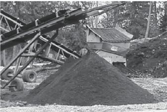
カナダのブリティッシュコロンビア州においては、ランドスケープ土に雨水を浸透・保水させて流出抑制 (rainfall capture: 蓄雨) を図る手法が実施されている。また、ランドスケープ土に対する基準 (British Columbia Landscape Standard) が用意されており、現地で既存の表層土壌に有機物を混合したり、工場にて人工的に配合して製造されている。ランドスケープ土は、一般的にその土壌体積の約10% (砂質土が母材の場合) から20% (ローム土が母材の場合) の水を貯留することができる。
