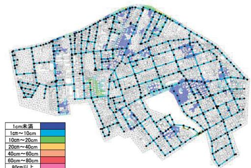
図-6 GI 全対策導入時の氾濫解析の結果(極端豪雨)
