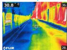
「J・ミックス※」が施工された部分は、浸透した雨水がしみ上がり蒸発すること(打ち水効果)により温度低減が見られる
