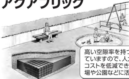
高い空隙率を持つプラスチック貯留材を使用していますので、人力による迅速な施工でトータルコストを低減できます。また、上部の土地は駐車場や公園などに活用できます。
